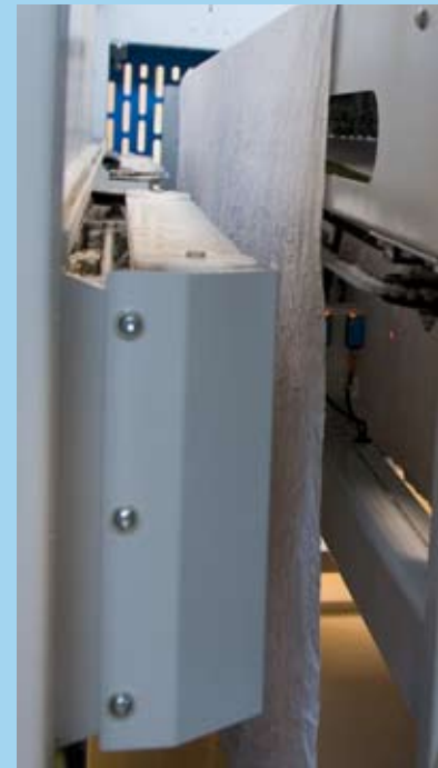
Spreizbürsten neben dem Conveyor bearbeiten die Seitenkanten der Wäsche.
