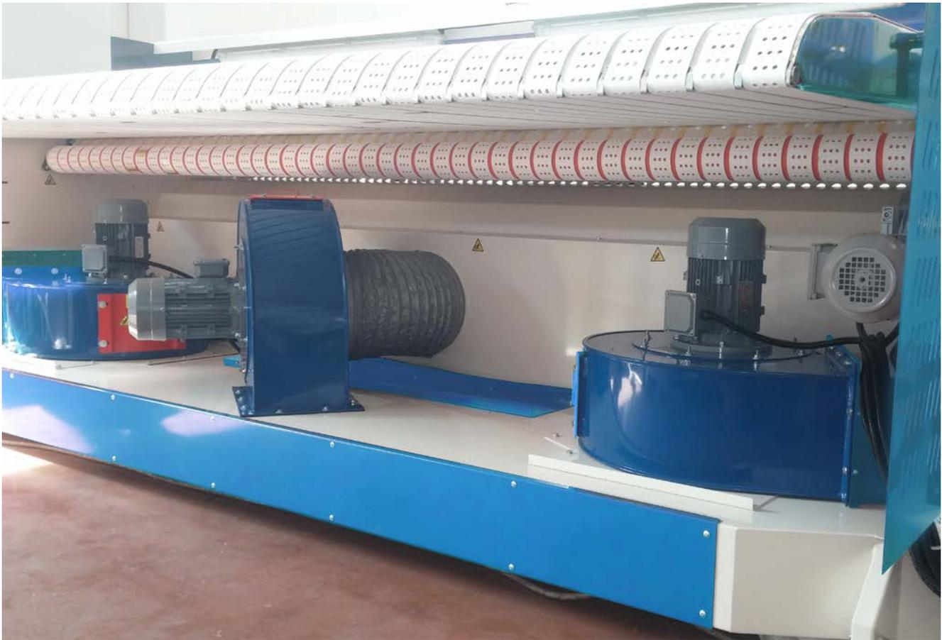
Le convoyeur avec aspiration et la chambre «Ventomat» déplient et étirent efficacement le linge humide.
